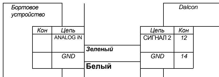
Рисунок 14 – Схема подключения Dalcon к аналоговому входу (0...+2,5В)
